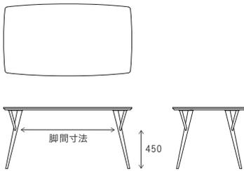
K2タイプはデザイン上、間口(W)方向の寸法と奥行き(D)方向の寸法の組み合わせにより、W寸法が同じ場合でも脚間寸法が異なります。(下図参照)
